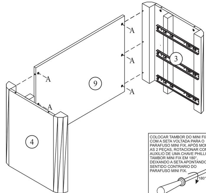
COLOCAR TAMBOR DO MINI FIX COM A SETA VOLTADA PARA O PARAFUSO MINI FIX, APÓS MONTAR AS 2 PEÇAS, ROTACIONAR COM AUXILIO DE UMA CHAVE PHILLIPS O TAMBOR MINI FIX EM 180°, DEIXANDO A SETA APONTANDO O SENTIDO CONTRARIO DO PARAFUSO MINI FIX.
