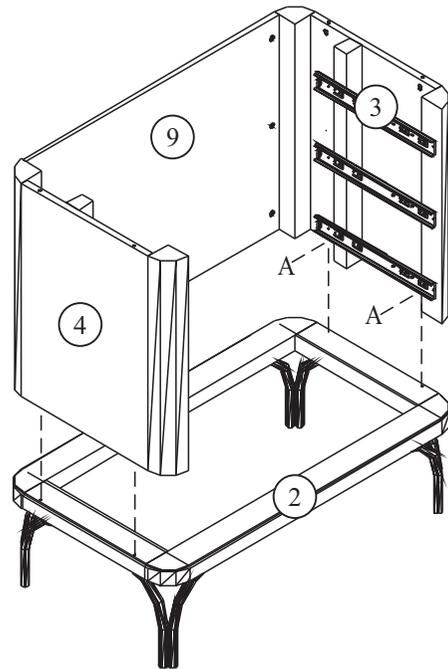
COLOCAR TAMBOR DO MINI FIX COM A SETA VOLTADA PARA O PARAFUSO MINI FIX, APÓS MONTAR AS 2 PEÇAS, ROTACIONAR COM AUXILIO DE UMA CHAVE PHILLIPS O TAMBOR MINI FIX EM 180°, DEIXANDO A SETA APONTANDO O SENTIDO CONTRARIO DO PARAFUSO MINI FIX.
