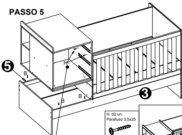
Travar a Cômoda na Cabeceira após a montagem sobre as Barras 3 e 5 com os Parafusos H
