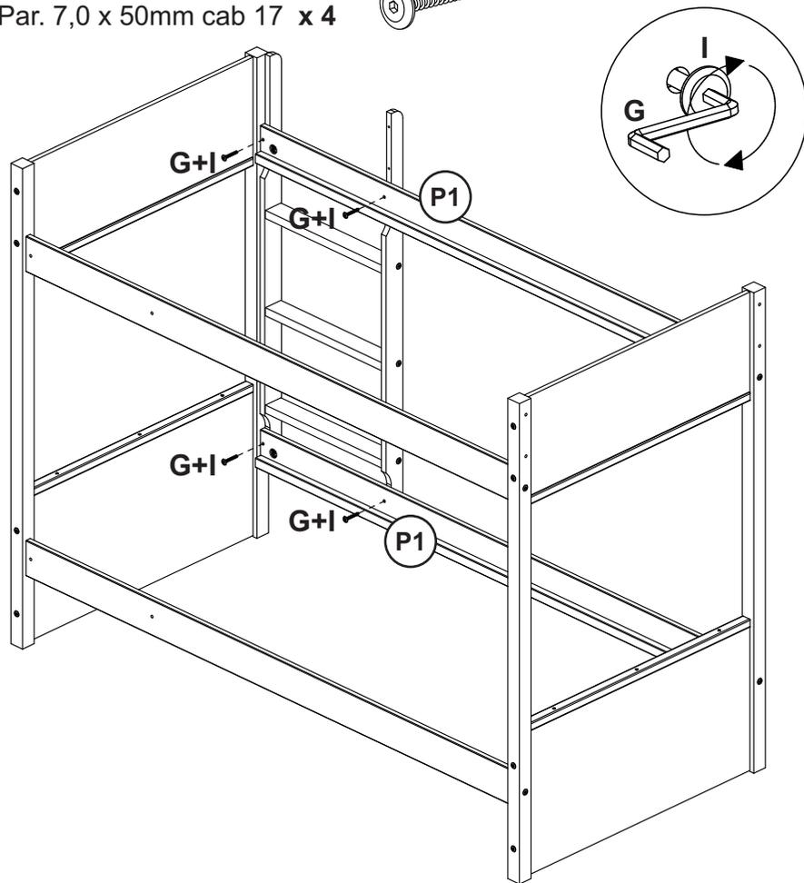
**10.** Encaixar a peça (4) e fixar na cabeceira e na escada utilizando os parafusos B e I
