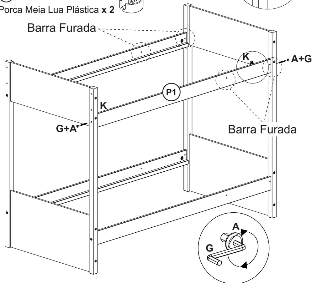
**7.** Encaixar o canal das peças (12) nas peças (3 e 5) e fixar utilizando os parafusos M.
