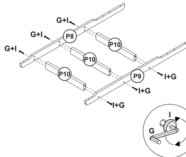
**9.** Encaixar a escada nas peças (1) e fixar utilizando os parafusos I.
