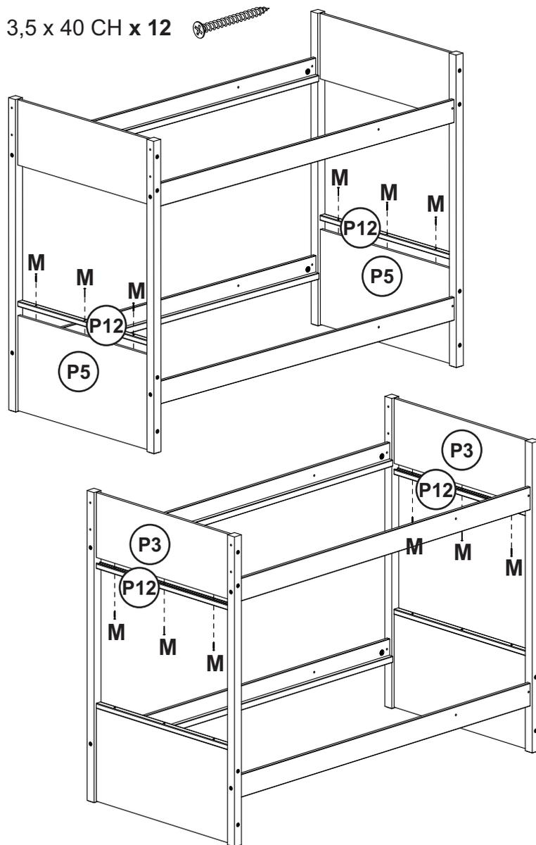
**8.** Fixar as peças (10) nas peças (8 e 9) utilizando os parafusos I.
